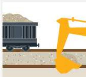
Le ballast est retiré par un engin de terrassement sur une couche d'approximativement 20 cm. Il est trié, réinséré puis mis à niveau une première fois.
