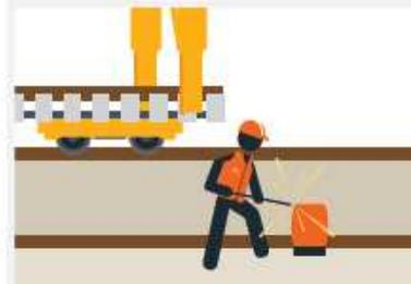
Acheminement du nouvel appareil. L'engin repose l'appareil de voie au millimètre près. Les soudures sont réalisées et une bourreuse mécanique lourde vient tasser le ballast et le niveler selon les prescriptions techniques.
