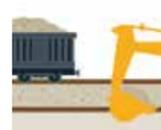
Le ballast est retiré par un engin de terrassement sur une couche d'environ 20 cm. Il est trié, réinséré puis mis à niveau une première fois.
