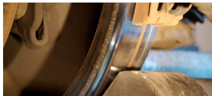
Réusinage d'une roue en atelier pour supprimer le méplat
